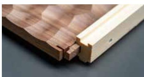
Das Fertigformat ist mit einem Sägeschnitt angedeutet. Kleine Fräsausrisse am Rand der Platte fallen somit weg.
