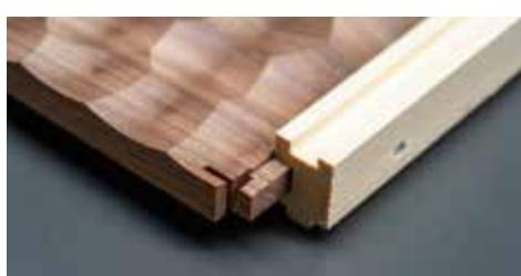
Das Fertigformat ist mit einem Sägeschnitt angedeutet. Kleine Fräsausrisse am Rand der Platte fallen somit weg.
